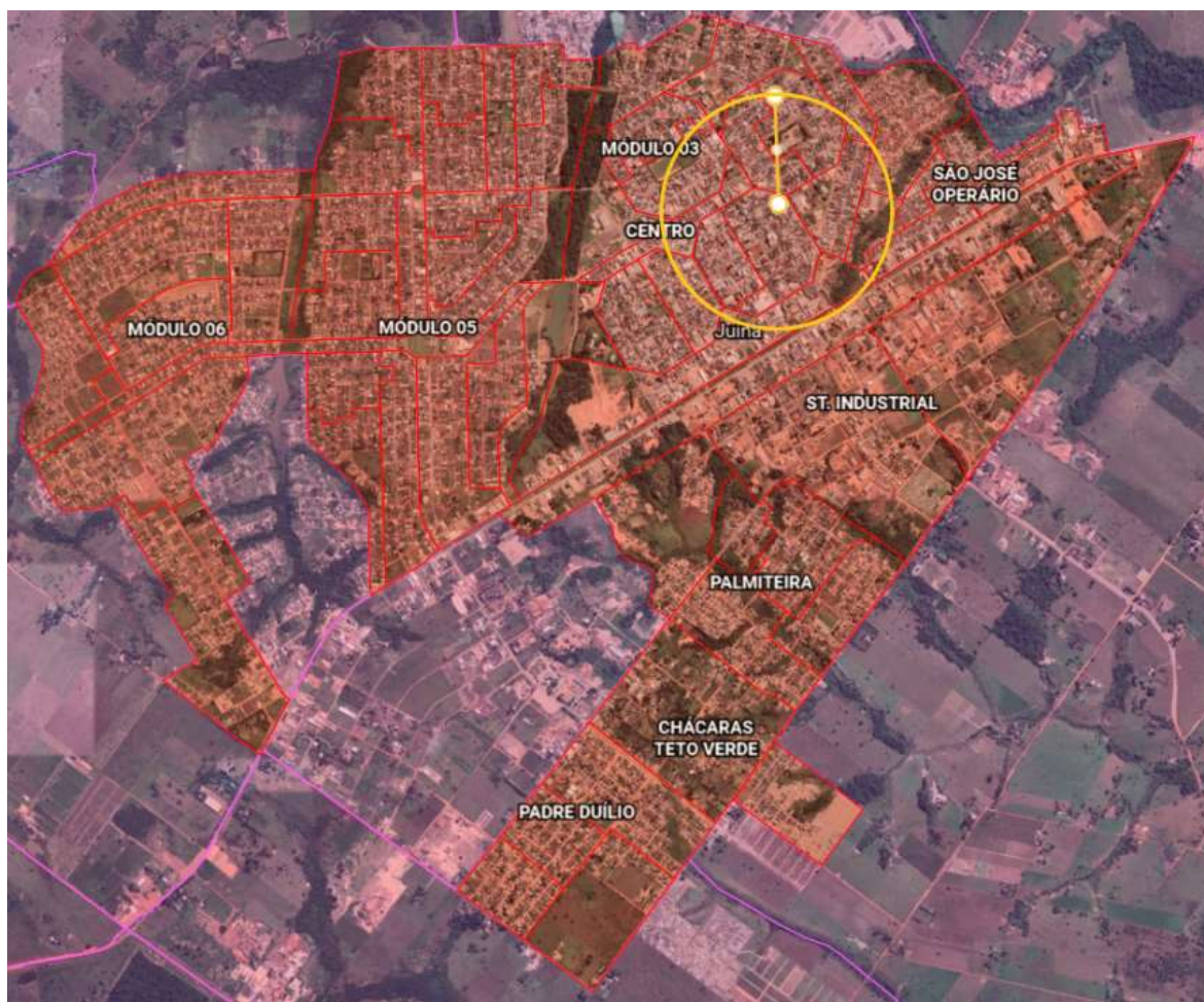
Figura 6 - Cobertura aproximada de uma ERB em 3,5 GHz para a cidade de Juína (MT)
