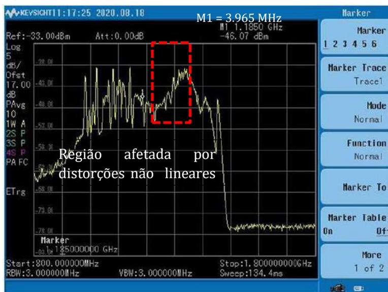
Figura 237 – Espectro Total em V - IMT-2020 com 60 MHz em 3670 MHz
