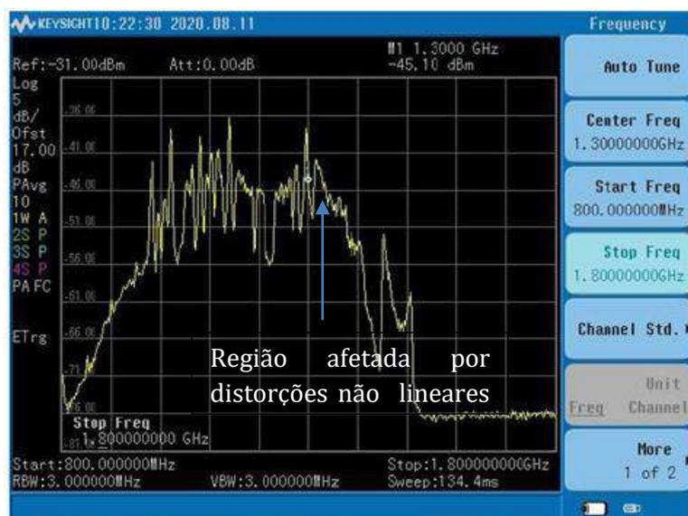
Figura 169 – Espectro Total em V - IMT-2020 com 60 MHz em 3670 MHz
