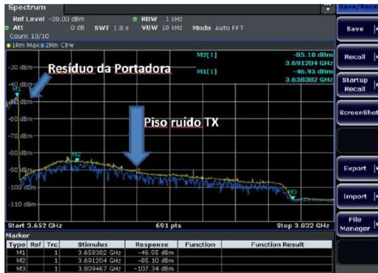
A Figura 55 mostra a região de transição de emissões fora de faixa, logo após 3,8 GHz. Conforme pode ser verificado até aproximadamente 3,817 GHz tem-se um sinal acima do piso de ruído do instrumento. Entre 3,817 GHz e 3,845 GHz o nível é ligeiramente maior do que o do piso do instrumento, tornando-se desprezível em algum valor entre esses dois extremos.
