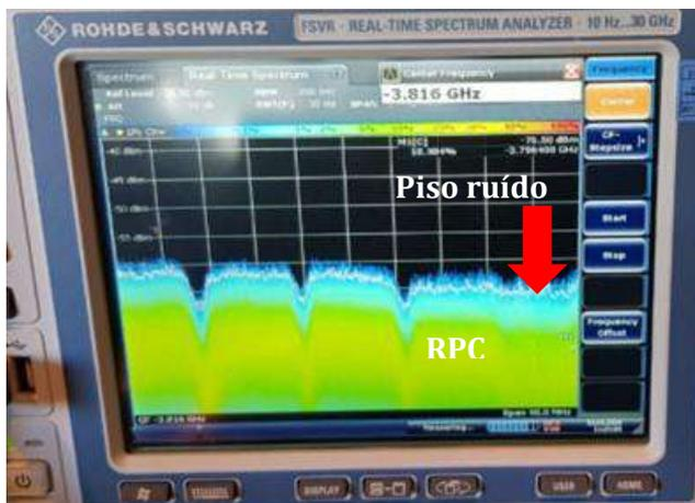
Claramente ocorre uma elevação o piso de ruído nas proximidades do canal de teste RPC (freq. 3807 MHz), elevação que, comparativamente a outros canais de teste, provocava uma degradação do desempenho.
