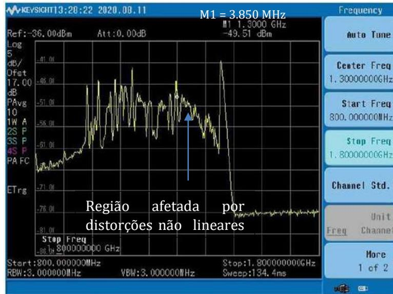
Figura 204 – Espectro Total em V - IMT-2020 com 60 MHz em 3670 MHz
