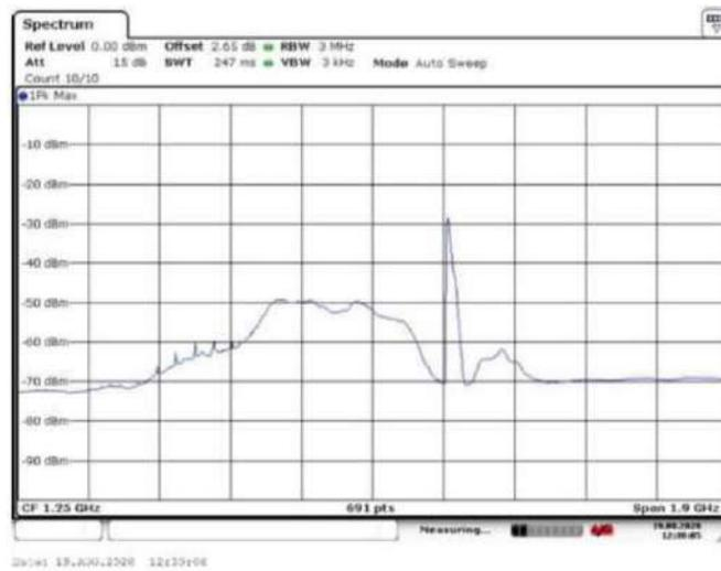
Figura 22 – Amostra 10: resposta em frequência de 3,3 a 3,7 GHz; polarização horizontal; nível de entrada: (ponto de compressão de 1 dB) -3 dB.
