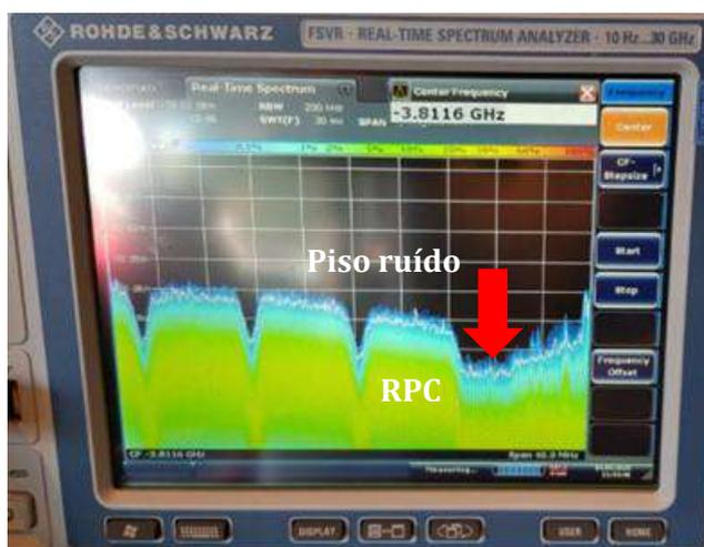
Figura 48 - Exemplo do espectro em Banda L, região de 3,8 GHz, com gNodeB B43 ligada com portadora em 3,65 GHz e BW = 100 MHz configurada com máxima potência do sistema.
