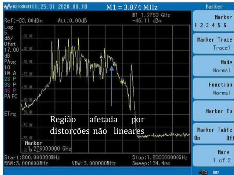
Figura 239 – Espectro Total em V - IMT-2020 com 60 MHz em 3670 MHz
