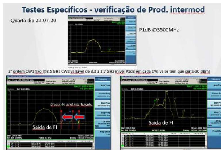
A pré-avaliação do resultado do teste em laboratório de *sweep* das amostras 6, 7 e 10 indicavam que o impacto para a amostra 6 seria limitado enquanto para as amostras 7 e 10 o impacto seria muito mais significativo quando tomado como base sinais de entrada com nível na ordem de -30 dBm. Essa pré-avaliação motivou a adequação do caderno de teste de campo para a verificação das amostras utilizando dois sinais interferentes, isto é, duas portadoras 5G cada uma com largura de faixa de 100 MHz.
