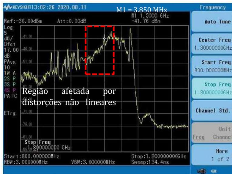
Figura 200 – Espectro Total em V - IMT-2020 com 60 MHz em 3670 MHz
