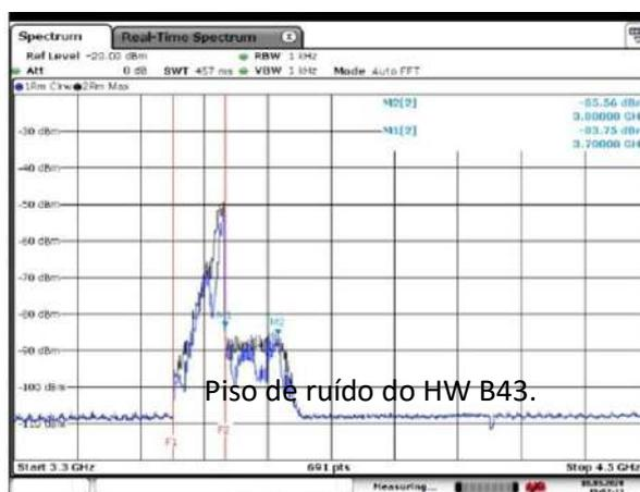
Conforme observado acima, para os sistemas FSS, a análise da faixa de guarda tem uma importância maior pois as emissões indesejáveis do sistema transmissor (5G) são vistas como interferência *inband* (co-canal) pelo sistema receptor, onde o filtro do dispositivo receptor não discerne o sinal desejado do interferente, não havendo possibilidade de mitigação pelo lado do FSS. Nesse caso, fica a mitigação a cargo do sistema de transmissão interferente, isto é, o 5G.
