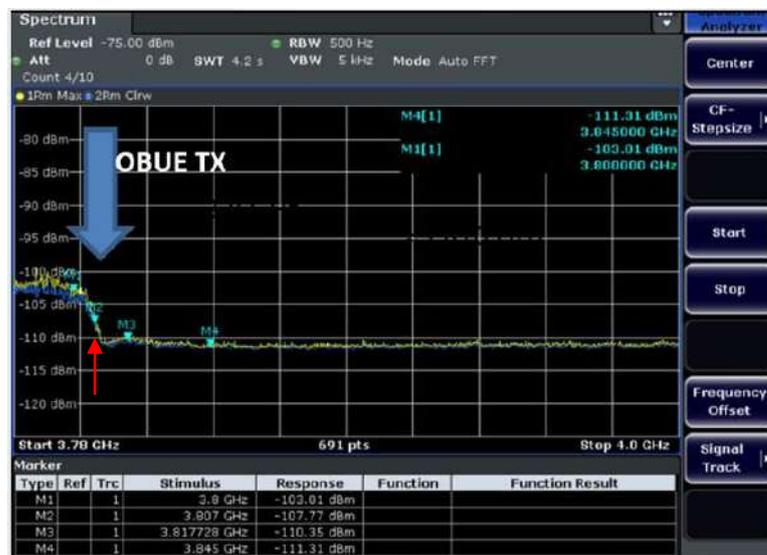
De posse desses dados pode-se concluir que com a presença de somente uma portadora em 3,65 GHz com largura de faixa de 100 MHz o impacto observado no desempenho do canal RPC se devia principalmente ao efeito das emissões fora de faixa da gNodeB B43, o que em tese não deveria existir quando se define o final da faixa de IMT em 3,7 GHz.
