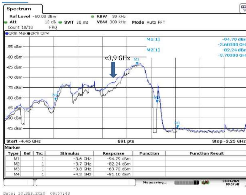
A Figura 64 ilustra intermodulação da amostra 10 quando foi configurada duas portadoras: gNodeB B43 com uma portadora 3,65 GHz/100 MHz e a gNodeB B42 com uma portadora 3,55 GHz/100 MHz, ambas configuradas com *backoff* de 15 dB.
