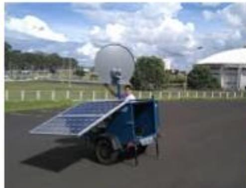
UMI – Unidade Móvel de Internet com energia solar e autonomia para 72 horas sem recarga. KU
